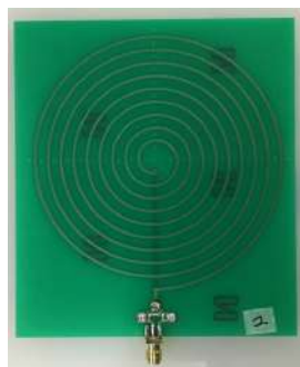
送電アンテナ
